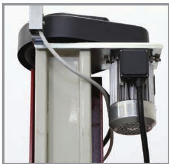
Due motori speciali autofrenanti ad alto rendimento per garantire potenza e durata nel tempo, dotati di sonda termica di protezione
