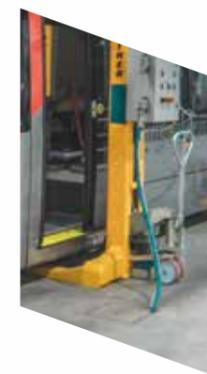
**Fácil de transportar:** las columnas móviles están equipadas con un sistema de desplazamiento tipo transpaleta que garantiza un desplazamiento sencillo y una maniobrabilidad óptima, incluso en espacios angostos.
