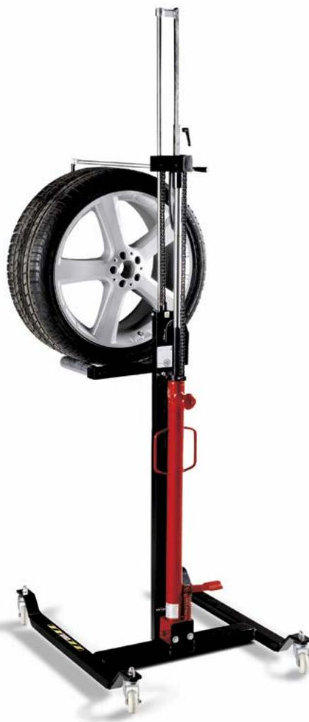
Soluzione ergonomica per smontare, spostare e montare in modo facile e sicuro ruote in alluminio fino a 24" con pneumatici a profilo basso (Diametro esterno massimo 820 mm) • Sollevamento facile a pedale • Rulli con cuscinetti a sfera per ruotare e posizionare facilmente • Facile accesso ai bulloni delle ruote. La ruota è posizionata lontano dal pistone principale.
